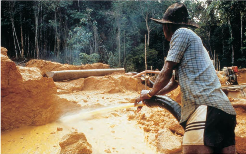
Qui sopra: *garimpeiro* lava la sabbia del fiume con potenti getti d'acqua per una prima separazione delle pagliuzze d'oro. A destra: veduta dell'area del garimpo di Paapiú.
